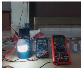
Gambar 9. Pengujian Output Baterai Menggunakan Beban Lampu 10W
