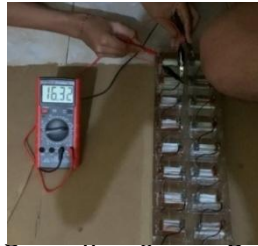
Gambar 7. Pengujian Output Baterai Tanpa Beban
