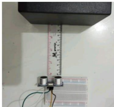
Gambar 8. Pengujian Sensor Ultrasonik HCSR04
