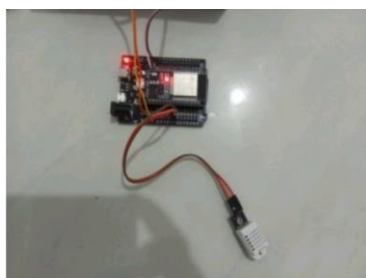
Gambar 7. Pengujian Sensor DHT22
