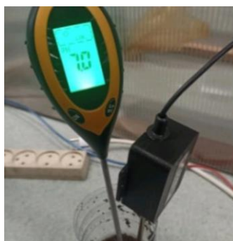
Gambar 5. Pengujian sensor pH tanah
