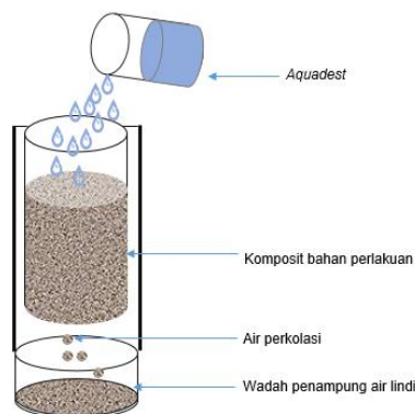
Gambar 1. Desain Pot Perkulator dan Wadah Penampung Air Terlindi pada Pemberian Aquadest sebagai air hujan
