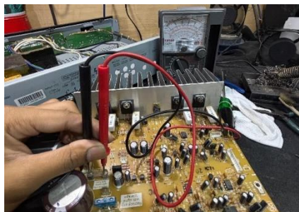
Gambar Fuse yang Tidak Mengalami Kerusakan
