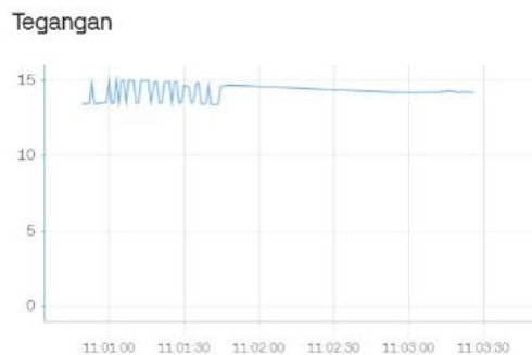
Gambar 9 Pemantauan Kinerja Tegangan Dilakukan Melalui Platform Blynk
